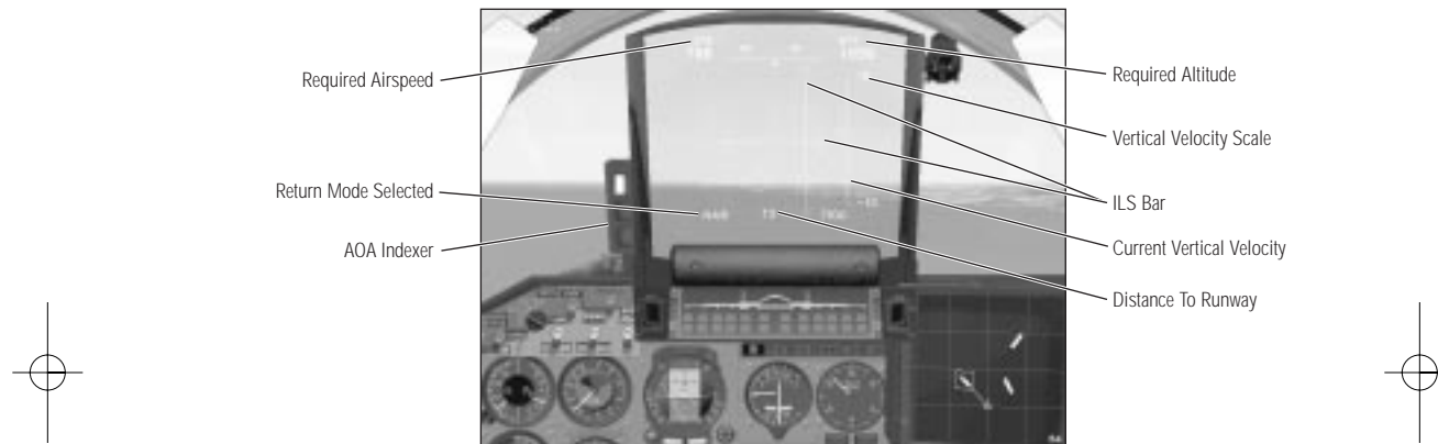
Figure 5-7: HUD symbology in Landing mode with the ALS
